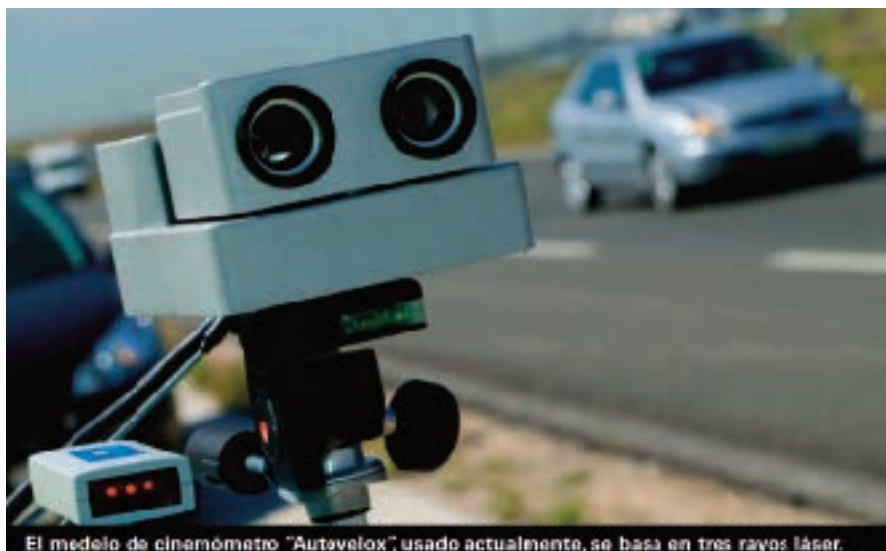
El modelo de cinemómetro "Autavelox", usado actualmente, se basa en tres rayos láser.
